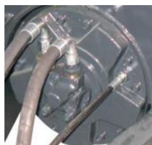
Traino idraulico alimentato da pompa trattore
