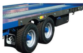
Piatti di contenimento imbullonati
