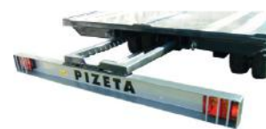
Barra fari telescopica idraulica (tipo ACI)
